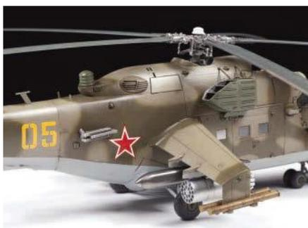
Details wie die Heißluftverteiler oder Täuschkörperwerfer verzieren den Rumpf.
