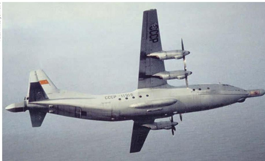
Modifikation An-12UD der sowjetischen Seekriegsflotte zur Seeüberwachung und U-Boot-Aufklärung. Dazu erhielt das Flugzeug ein Bugradar und am Heck ein Sonar zur Aufspürung von Magnetanomalien.
