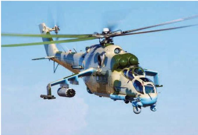
Ukrainische Kampfhubschrauber Mi-24P. Stärkere Triebwerke von Motor Sich sorgen für 1000 kg mehr Startmasse, ein elektro-optischer/IR-Sensor und ein Laserzielmarker für präzisere Waffenwirkung.
