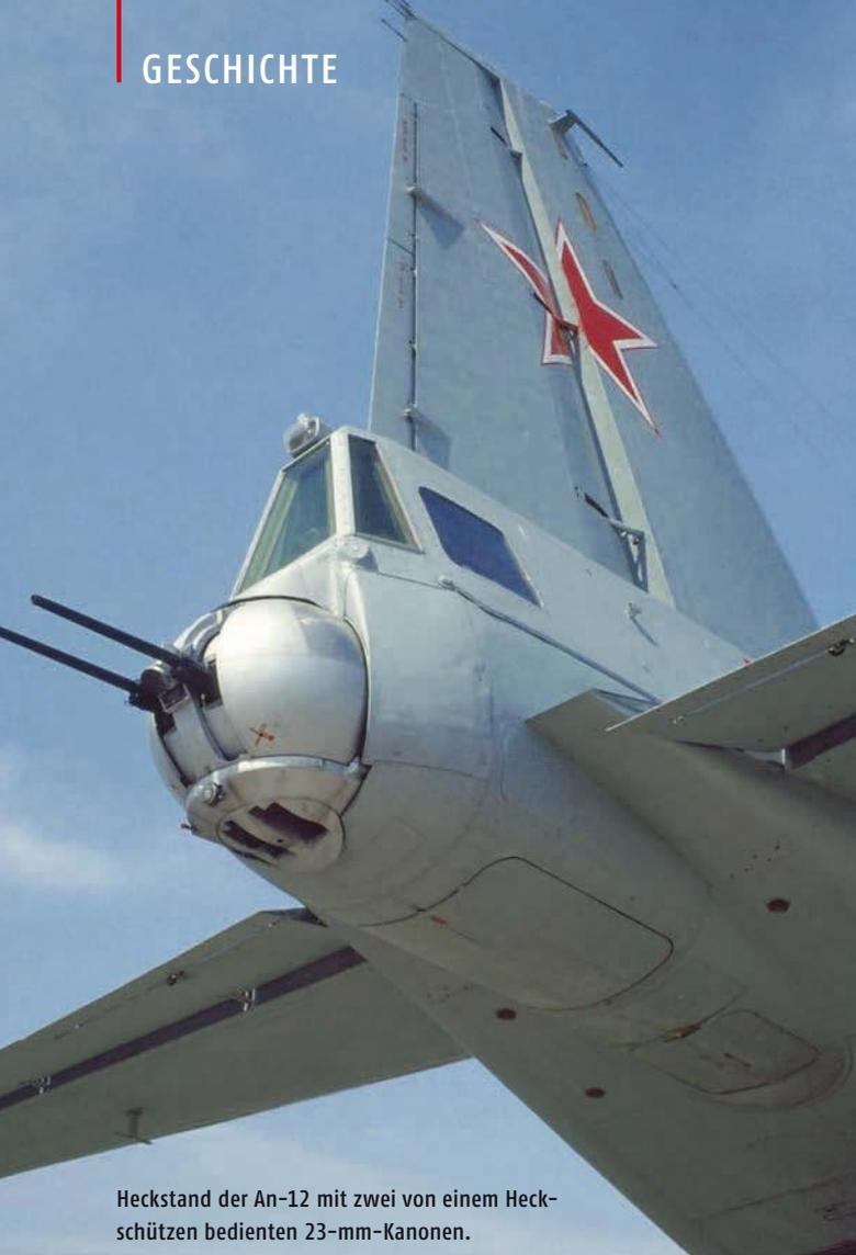
Heckstand der An-12 mit zwei von einem Heckschützen bedienten 23-mm-Kanonen.
