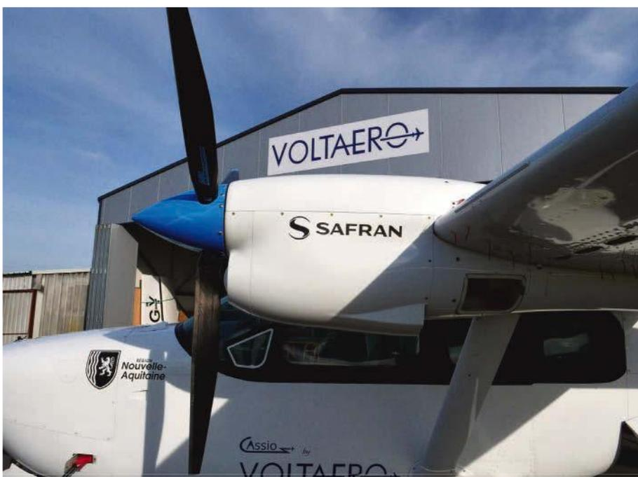
Die luftgekühlten ENGINeUS-45-Elektromotoren von Safran werden derzeit verwendet, um den Antriebsstrang zu testen – in Zukunft könnten sie gegen leistungsfähigere Muster getauscht werden.
