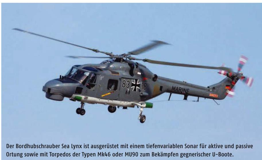
Der Bordhubschrauber Sea Lynx ist ausgerüstet mit einem tiefenvariablen Sonar für aktive und passive Ortung sowie mit Torpedos der Typen Mk46 oder MU90 zum Bekämpfen gegnerischer U-Boote.
