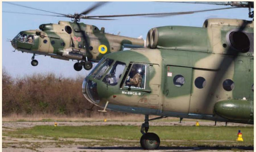
13 Hubschrauber Mi-8MSB-W wurden mit effizienteren Triebwerken, heimischer Bewaffnung, Display-Cockpit mit GPS sowie polnischen Nachtsichtbrillen nachgerüstet.
