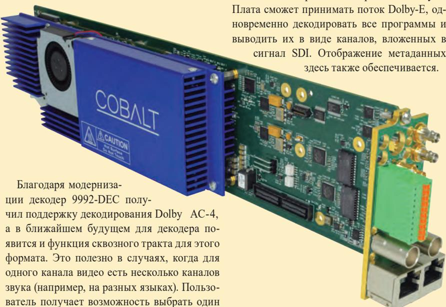
Благодаря модернизации декодер 9992-DEC получил поддержку декодирования Dolby AC-4, а в ближайшем будущем для декодера появится и функция сквозного тракта для этого формата. Это полезно в случаях, когда для одного канала видео есть несколько каналов звука (например, на разных языках). Пользователь получает возможность выбрать один из каналов для декодирования. Если же есть
