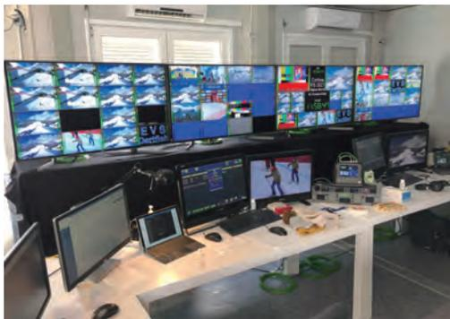
Полиэкранный видеостен, реализованный на базе vt\_dmv
