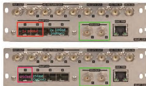
Модуль MoIP с двумя портами 10GbE (вверху) и одним портом 25GbE
